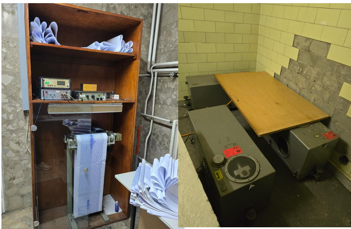
Слика 14: Приказ уређаја за мерење хоризинталних и вертикалних потреса из 1924. године
